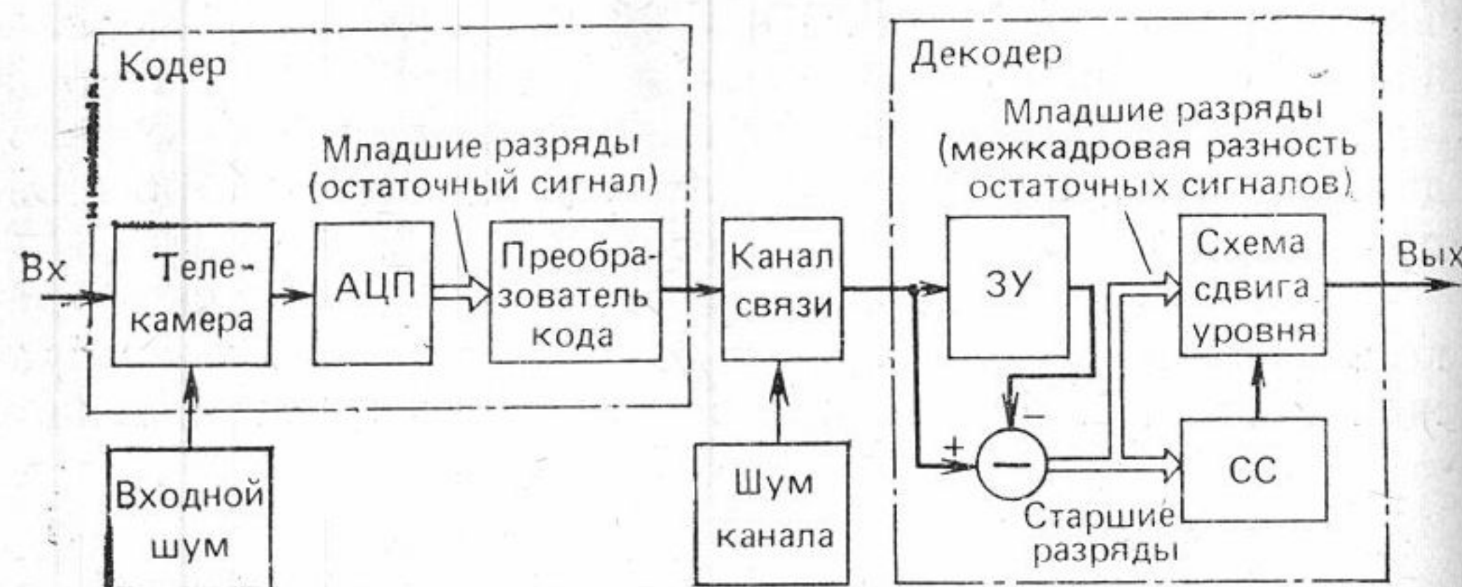
Рис. 2.19. Структурная схема телевизионной системы, реализующей кодирование межкадровых приращений сигнала изображения
