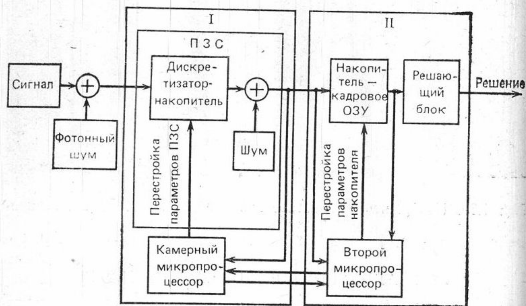
Рис. 1.41. Структурная схема адаптивной твердотельной системы с двумя перестраиваемыми фильтрами
