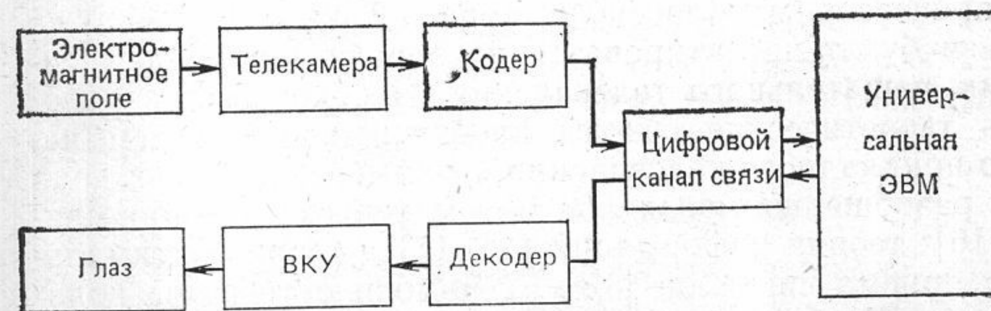
Рис. В.5. Визуальная телевизионная система, работающая на одной линии с ЭВМ
